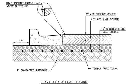
HEAVY DUTY ASPHALT PAVING
