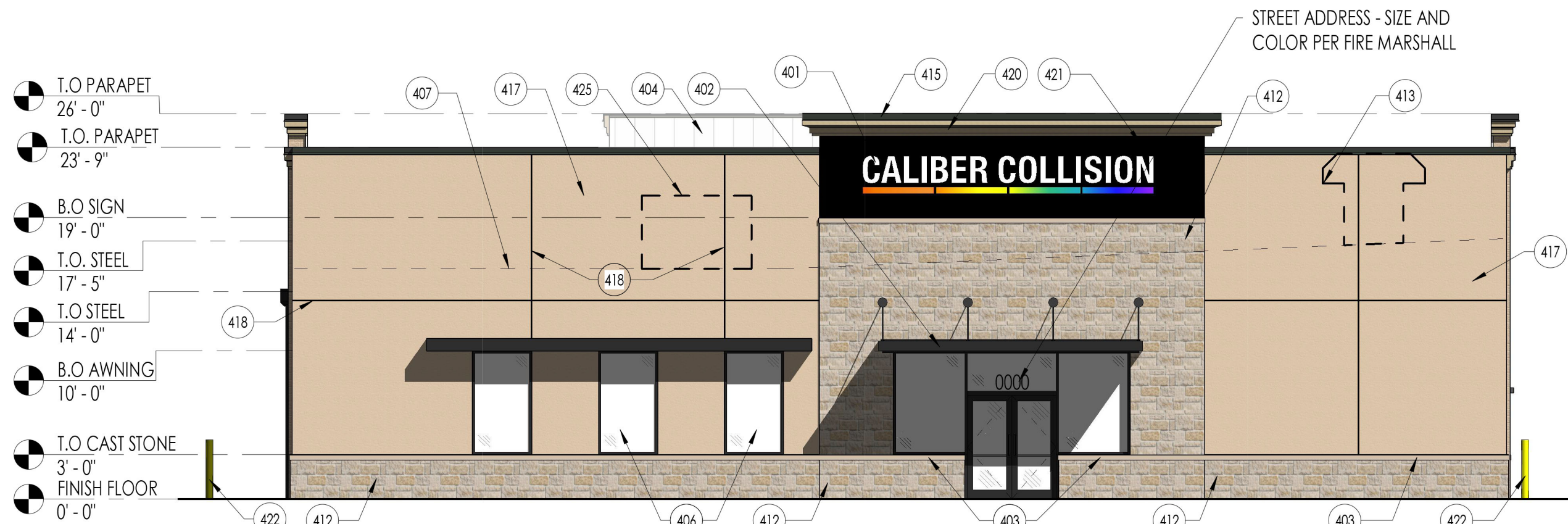
01 NORTH ELEVATION SCALE: 1/8" = 1'-0"
