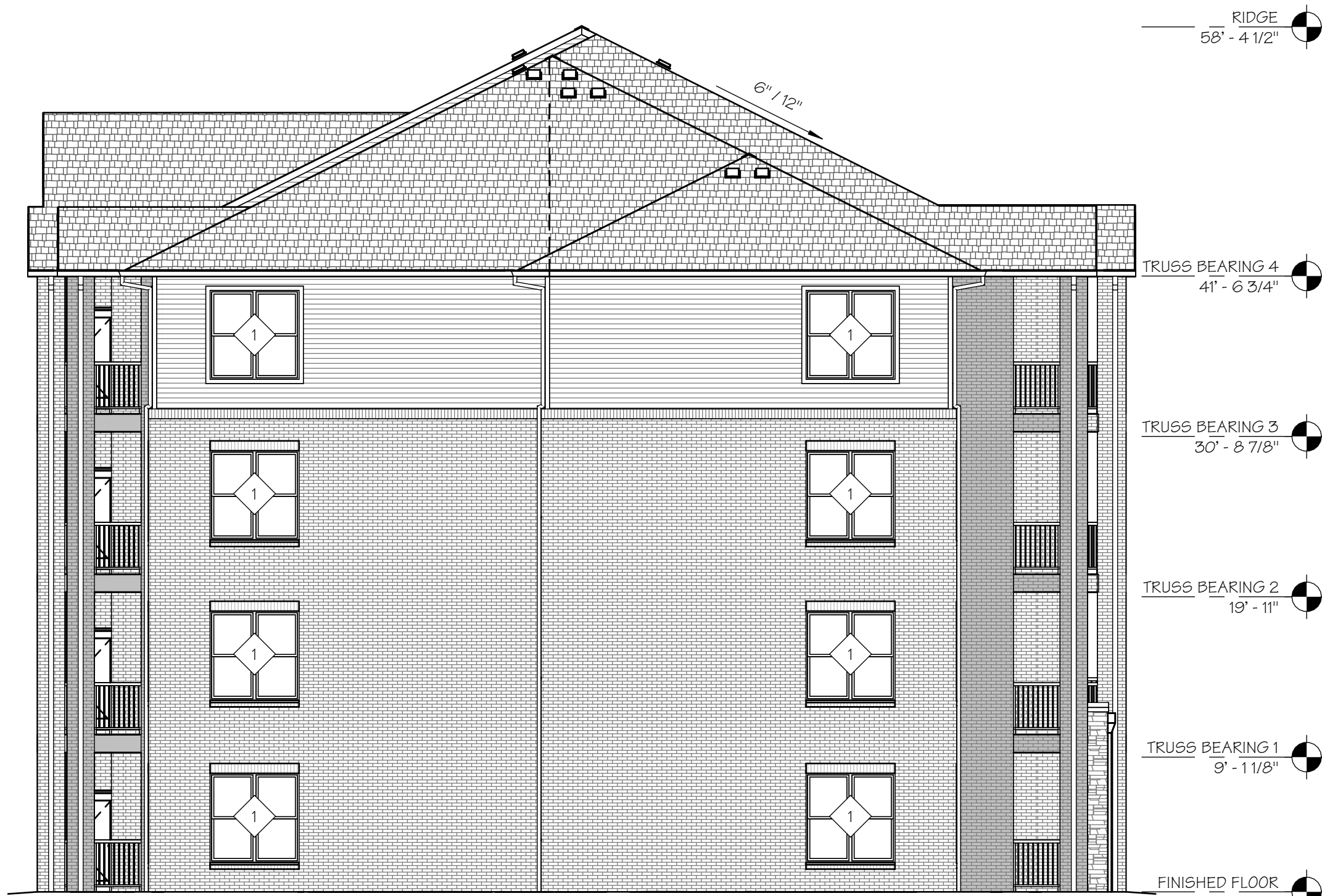
2 A3.0A LEFT SIDE ELEVATION SCALE: 1/8" = 1'-0"
