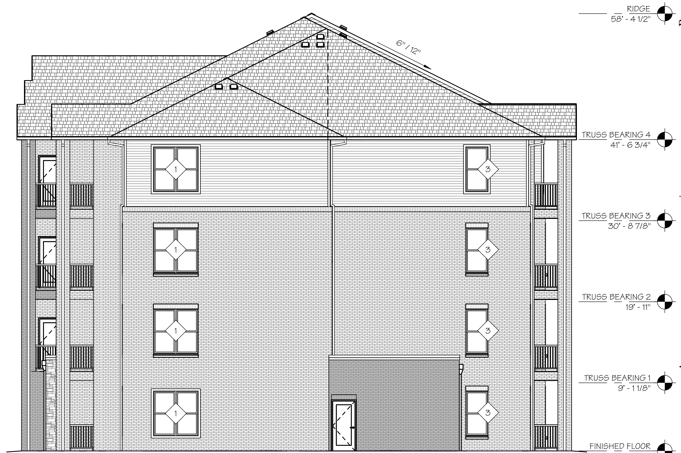
3 A3.0A RIGHT SIDE ELEVATION SCALE: 1/8" = 1'-0"
