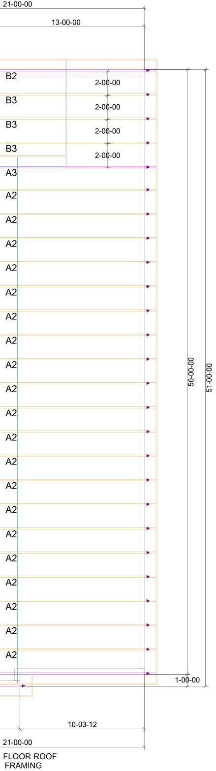
1 - SDWC 15600 REQUIRED AT ALL BEARING LOCATIONS (u.n.o.) ALL TRUSS TO TRUSS CONNECTIONS = 'NAILED" (u.n.o.)
