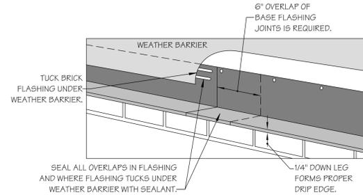
1 JOINT FLASHING DETAIL @ BRICK
