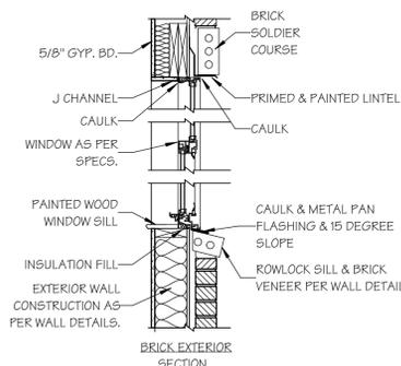
NOTE: FILL ALL VOIDS AROUND WINDOW UNITS W/INSULATION PRIOR TO GYP. BD. INSTALLATION
