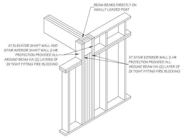
9 SHAFT BEAM PENETRATION
