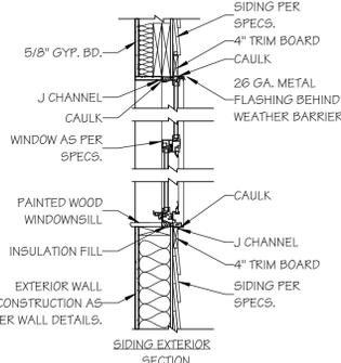
NOTE: FILL ALL VOIDS AROUND WINDOW UNITS W/INSULATION PRIOR TO GYP. BD. INSTALLATION
