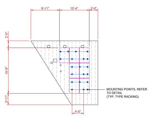
ARRAY 1 TILT: 31° AZIMUTH: 197° **ROOF MATERIAL: COMP SHINGLE**
