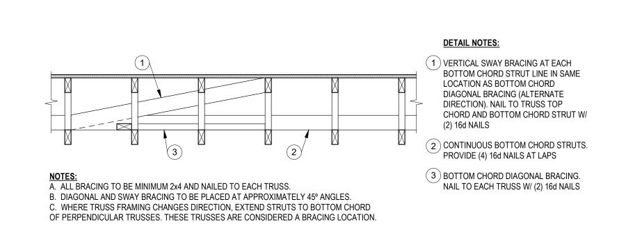
TYPICAL TRUSS BRACING DETAIL
