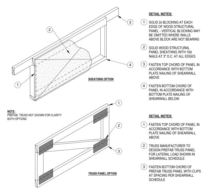
TYPICAL FLOOR/ROOF TRUSS BLOCKING
