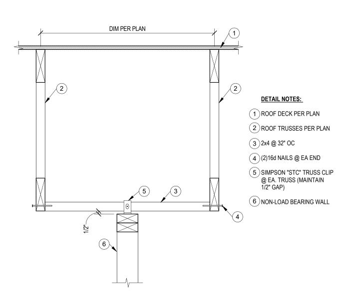
TYP - NON-LOAD BRG WALL - TRUSS
