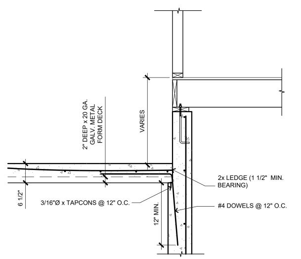
9 GARAGE SLAB ON FILL @ WALL
