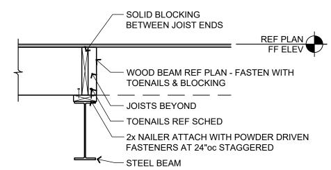
REF PLAN WD BEAM ON STEEL BEAM
