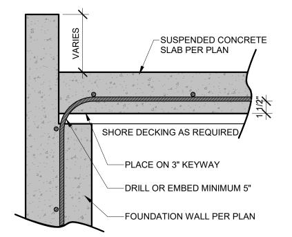
SUSPENDED SLAB/WALL CONNECTION
