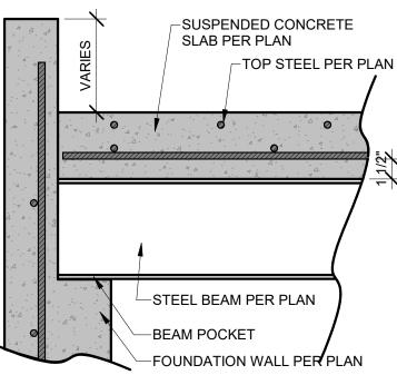
SUSPENDED SLAB BEAM/WALL CONNECTION
