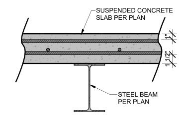
SUSPENDED SLAB/STEELBEAM CROSS SECTION
