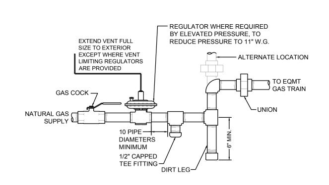
GAS EQUIPMENT **CONNECTION DETAIL** NO SCALE
