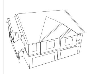
TRUSS QUANTITY 89 **GABLE AREA** 785 HIP LINES 0 115 HORIZONTAL OVERHANG LINES **RAKED OVERHANG LINES** 207 RIDGE LINES 79 **ROOF AREA** 3,105 VALLEY LINES 53
