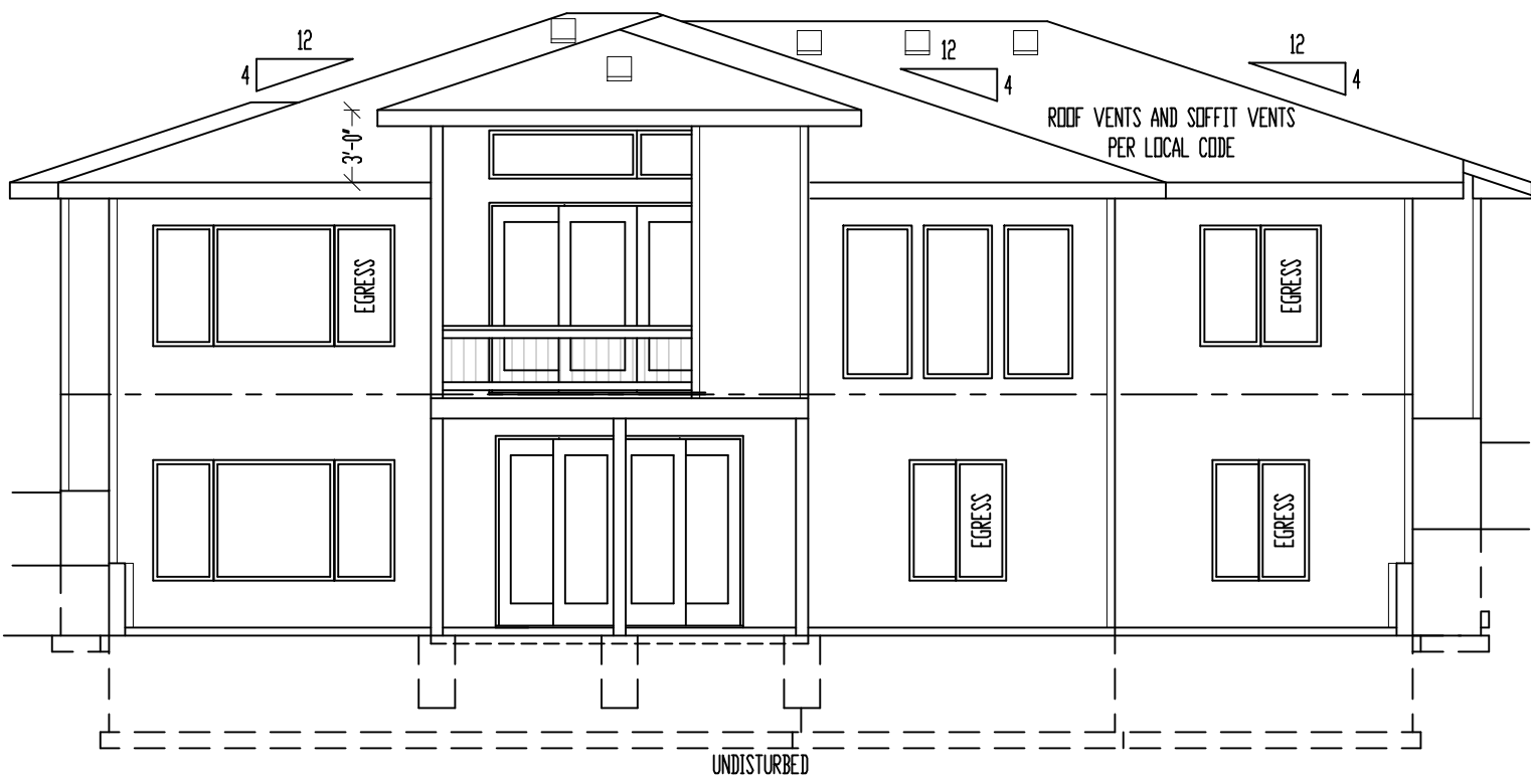
REAR ELEVATION SCALE: 1/8" = 1'-0"
