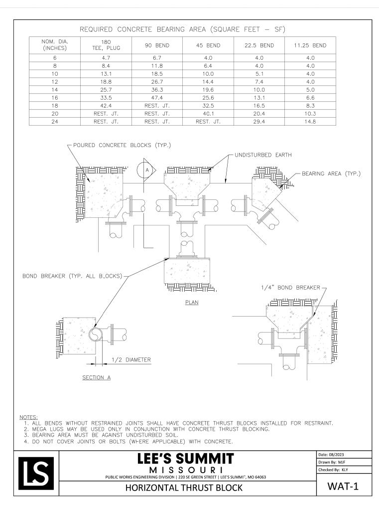
1 HORIZONTAL THRUST BLOCK DETAIL
