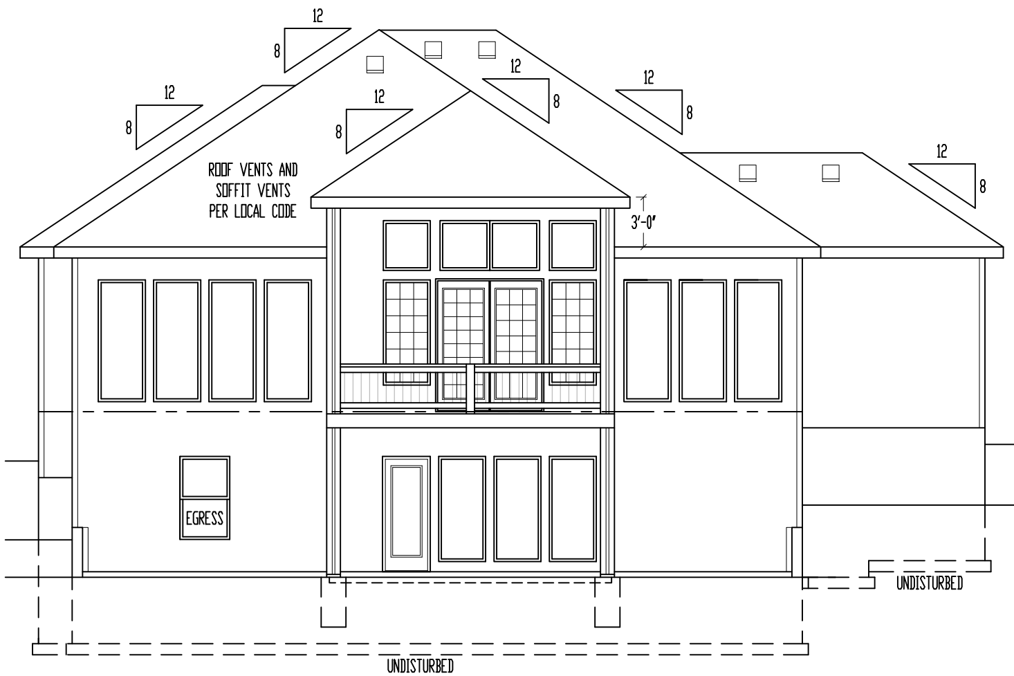
REAR ELEVATION SCALE: 1/8" = 1'-0"
