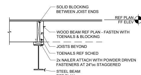
13 WD BEAM ON STEEL BEAM
