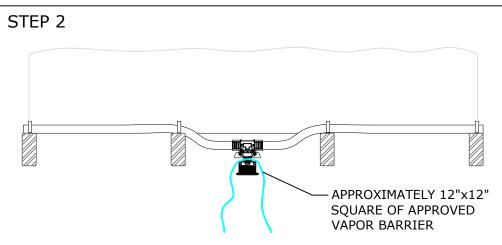
INSTALL SPRINKLER INTO THE SPRINKLER ADAPTOR TEE, LETTING THE 12"x12" SQUARE OF VAPOR BARRIER HANG DOWN OVER THE SPRINKLER
