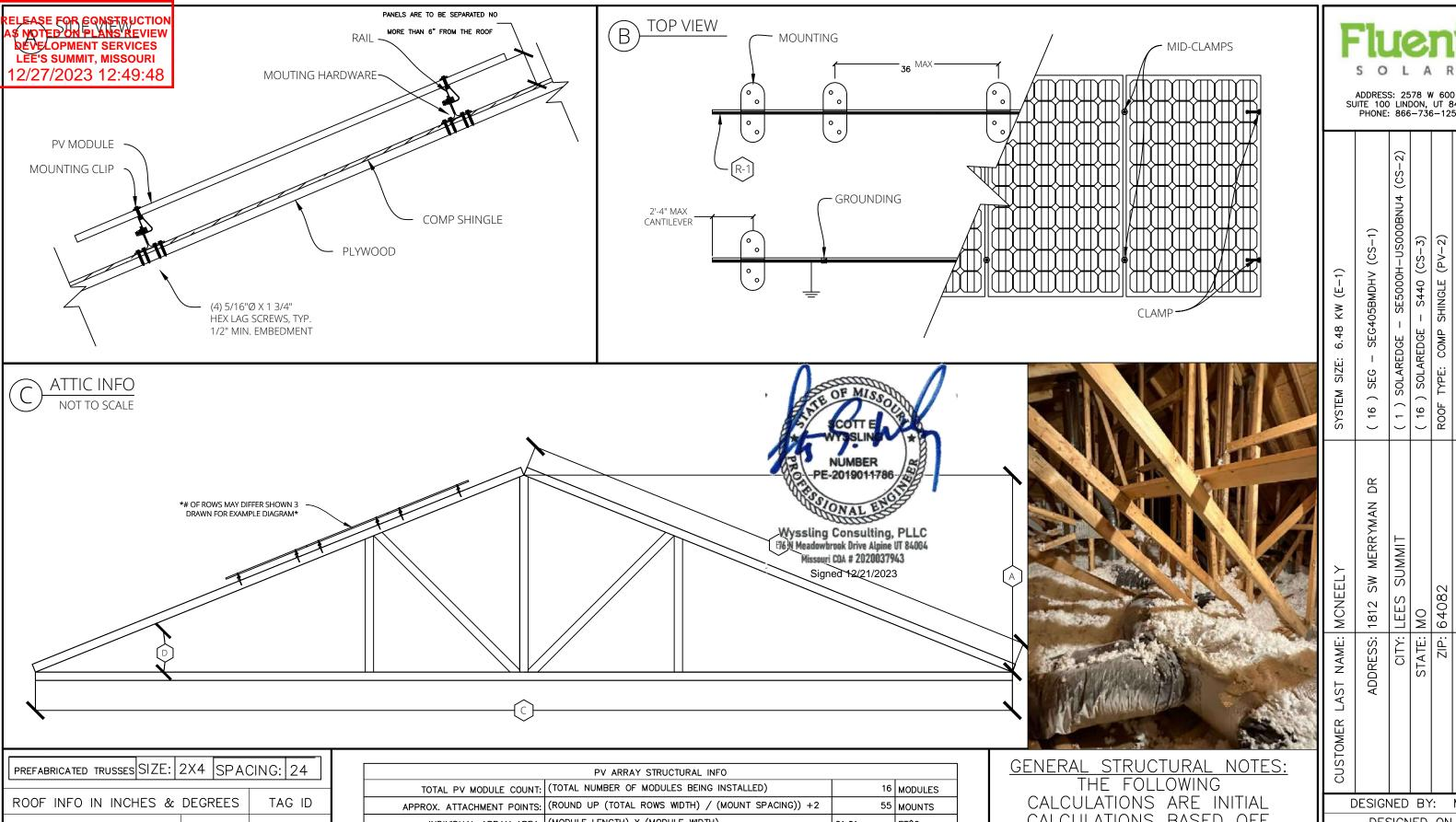
ROOF HEIGHT: 196 Α 305 В ROOF FACE SPAN: 468 С **ROOF LENGTH:** 40 ROOF TILT: D
