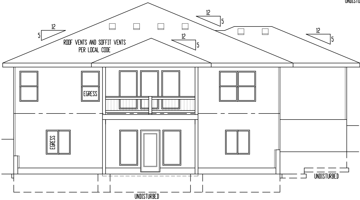
REAR ELEVATION SCALE: 1/8" = 1'-0"
