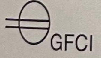
GFCI GFCI duplex GFCI receptacle
