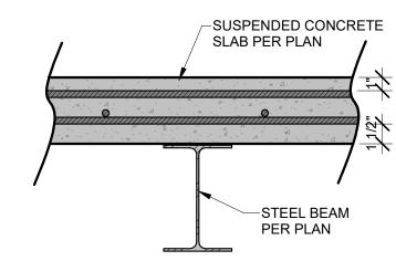
3 SUSPENDED SLAB/STEEL BEAM CROSS SECTION
