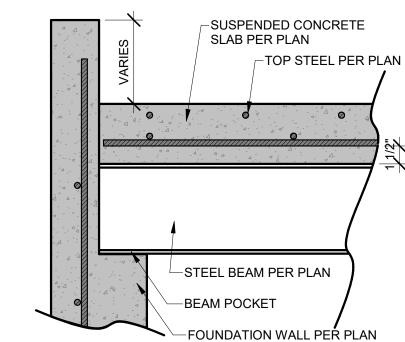
SUSPENDED SLAB BEAM/WALL CONNECTION
