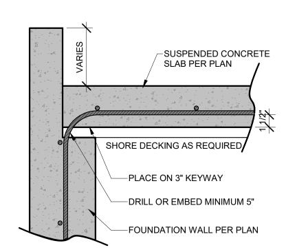
4 SUSPENDED SLAB/WALL CONNECTION
