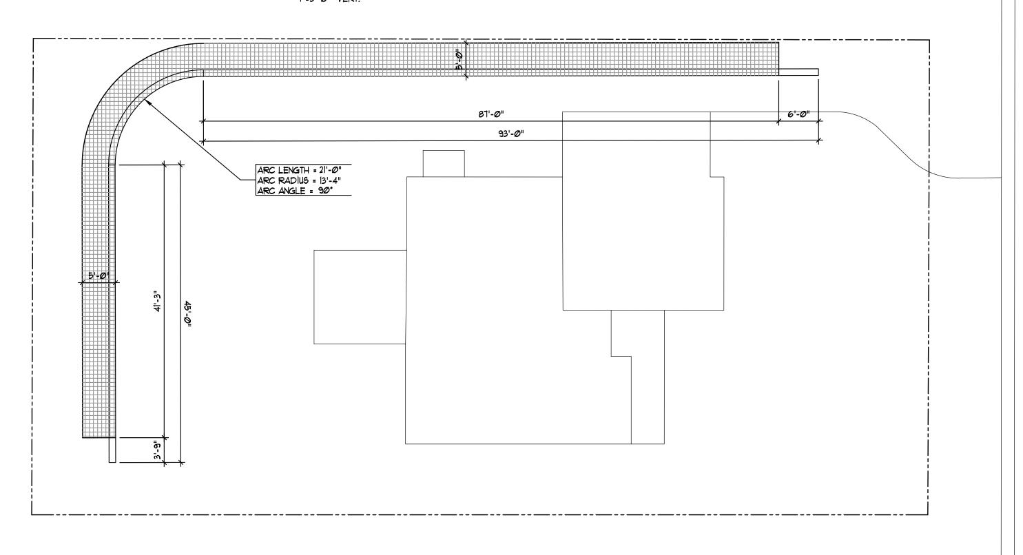
REINFORCED SOIL RETAINING WALL PLAN (HIND)
