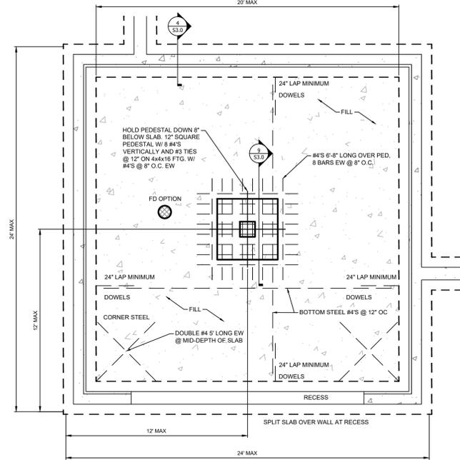
1 S3.0 GARAGE SLAB ON FILL N.T.S.
