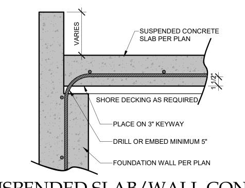
SUSPENDED SLAB/WALL CONNECTION
