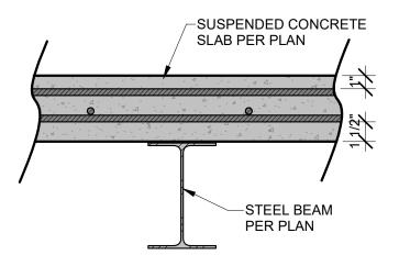
3 SUSPENDED SLAB/STEELBEAM CROSS SECTION
