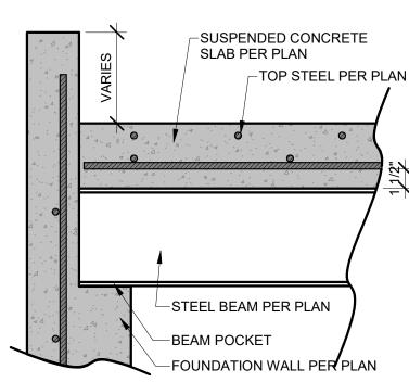
SUSPENDED SLAB BEAM/WALL CONNECTION
