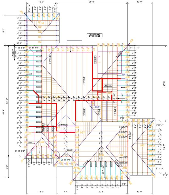
FRONT TO BACK PITCH 5/12 SOFFIT DESIGNED FOR 12" HEEL HEIGHT 8-9/16"
