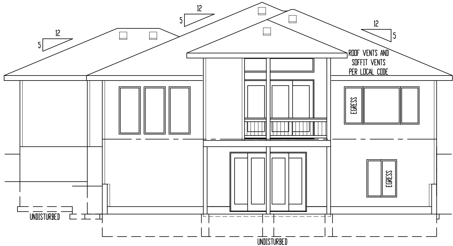
REAR ELEVATION SCALE: 1/8" = 1'-0"
