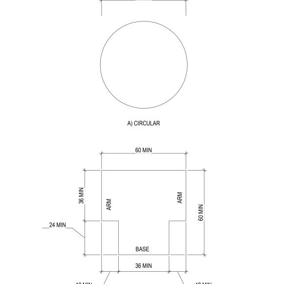
FIGURE 304.3.2 T-SHAPED TURNING SPACE
