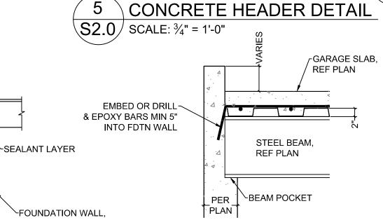
GARAGE SLAB BEAM BEARING
