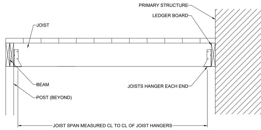
JOISTS WITH FLUSH BEAM
