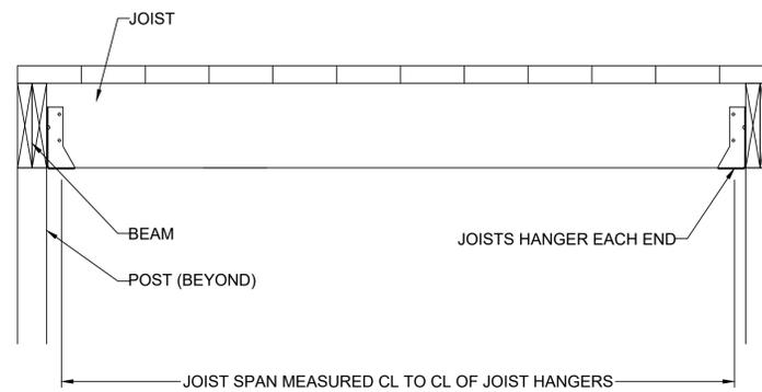
JOISTS WITH FLUSH BEAM
