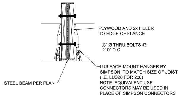
**5** CEILING JOIST TO FLUSH STEEL BEAM DETAIL
