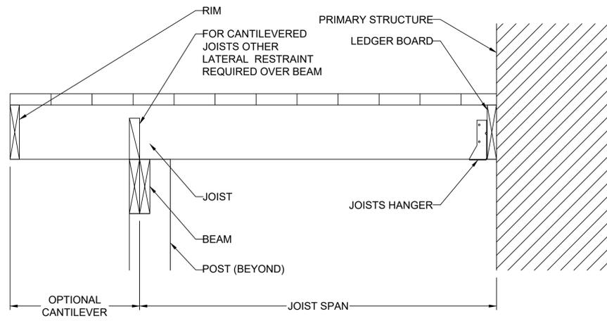
CANTILEVERED JOISTS WITH DROPPED BEAM
