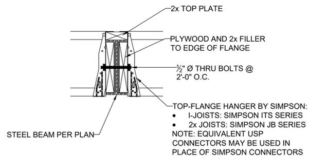
**4** FLOOR JOIST TO FLUSH STEEL BEAM DETAIL
