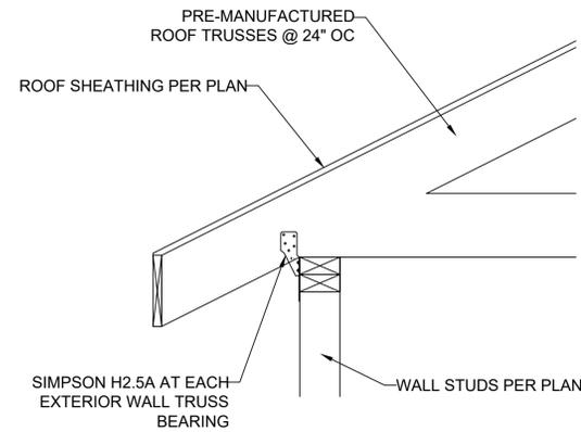
**2 TRUSS CONNECTION TO EXT. WALL BEARING**
